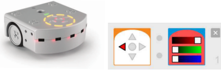
Abb. 1: Der Thymio II und eine Regel in VPL: Wenn „links“gedrückt wird, dann leuchte rot.
