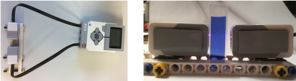
Abb. 2: Aufbau des Experiments mittels Stein, zwei Lichtsensoren und Kvettenhalterung fr photometrische Messungen
